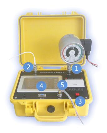
第一步:将被检仪表连接在压力输出口上(1),通讯线连接通讯口。
