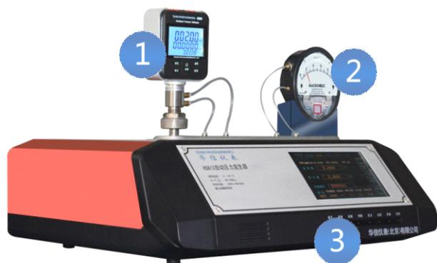
第一步：将相应量程的智能压力校验仪连接压力输出口，开机。
