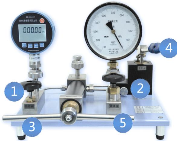
第一步：打开回检阀（1），将被检表与标准表连接在压力输出口上。
