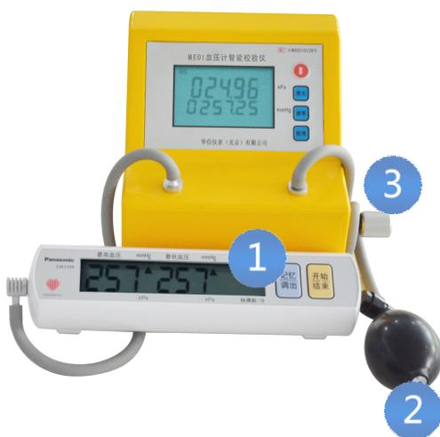
第一步：将被检血压计连接到输出口上，打开电源（1）。
